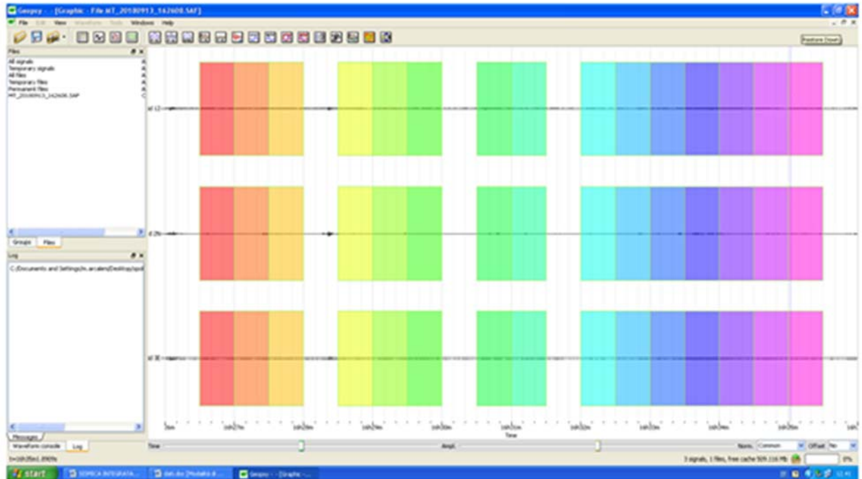
Sismogramma acquisito e finestre prese in esame per l’HVSr 03
