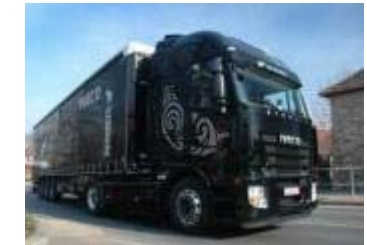
Autocarro pesante (IVECO STRALIS) allestimento frigorifero
