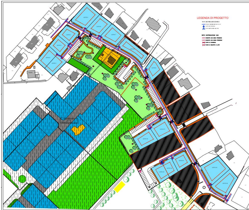
Rete di distribuzione idrica e gas
