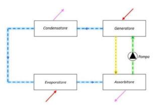
Talvolta, possono essere costituite anche da due generatori, il primo generatore lavorerà a pressione e temperatura maggiori rispetto al secondo. In questo caso si parla di macchina bistadio, quando la miscela viene riscaldata, non tutto il refrigerante riesce ad evaporare nel generatore, quindi, con il primo generatore evaporerà una parte di refrigerante, con il secondo evaporerà invece la restante. In tal modo migliora la prestazione globale della macchina.
