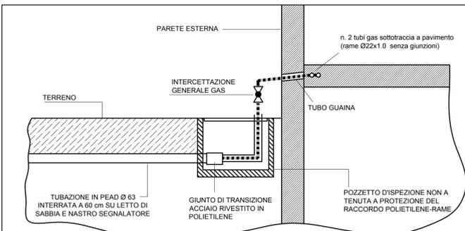
TUBAZIONE GAS GPL PARTICOLARE POZZETTO
