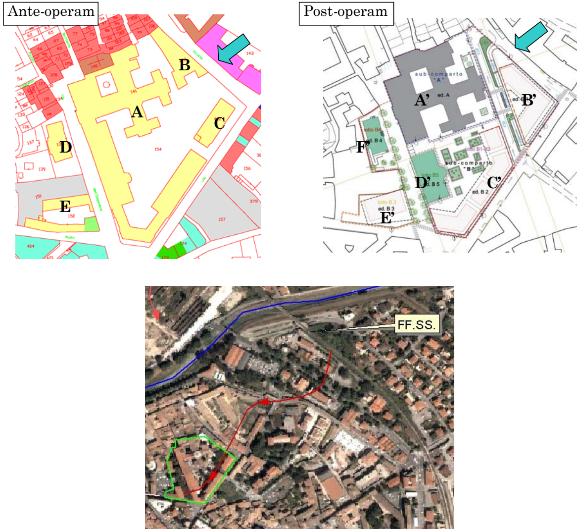
Figura 14. Identificazione degli edifici nella situazione ante-operam e post-operam in rapporto alle linee di flusso (polilinea rossa sotto, freccia campita celeste sopra) che caratterizzano la simulazione dell'esonazione extra-alveo (FMTPN_SX).
