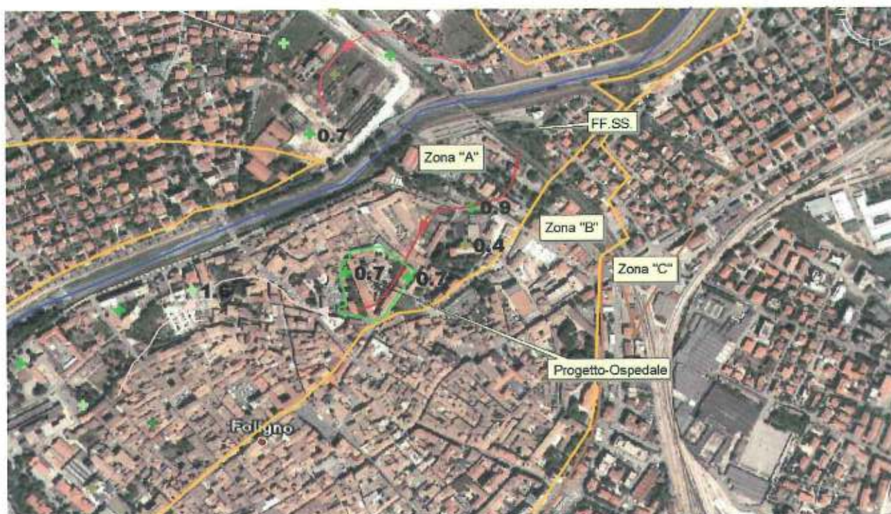
Figura 11. Planimetria cartografica con indicazione delle fasce fluviali, dei tiranti idrici attesi dell'evento con 50 anni di tempo di ritorno e delle linee di scolo extra-alveo in relazione all'area di studio (evidenziata in verde)
