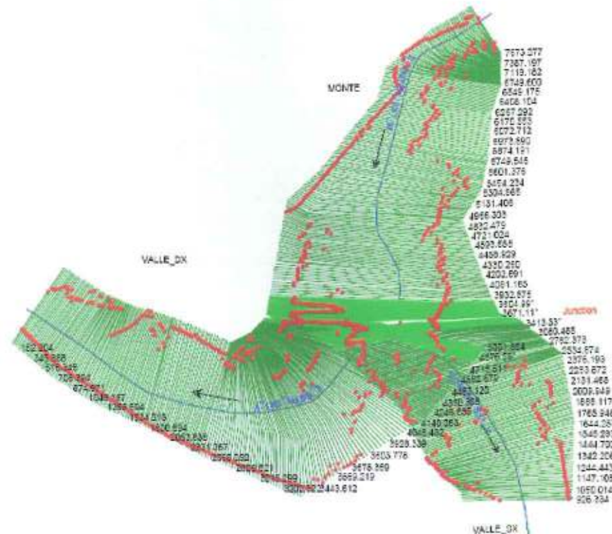
Figura 8. Schema planimetrico del sistema idraulico extra-alveo FMTPN_SX1 - Esondazione in sinistra idraulica del Topino in direzione Casavecchie e fiume Timia.
