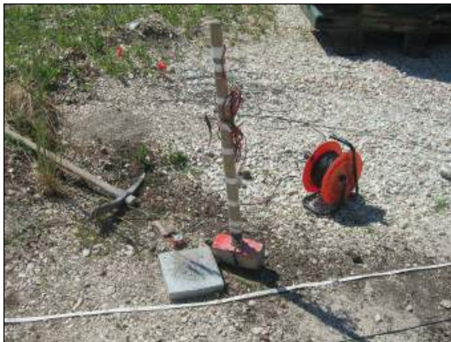
FOTO N°14: PIASTRA DI BATTUTA PER ENERGIZZAZIONE ONDE DI COMPRESSIONE
