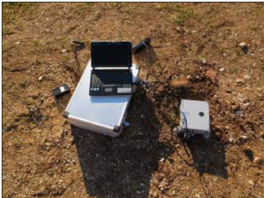
FOTO N°25: STAZIONE DI ACQUISIZIONE DELLA SISMICA PASSIVA HVSR (SARA mod. SR04/MT)
