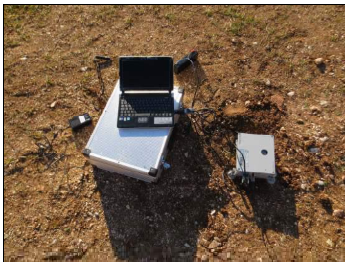
FOTO N°8: STAZIONE DI ACQUISIZIONE DELLA SISMICA PASSIVA HVSr (SARA mod. SR04/MT)
