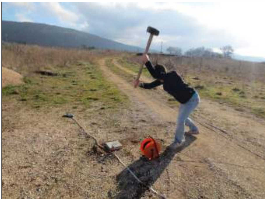
FOTO N°22: ENERGIZZAZIONE ONDE DI COMPRESSIONE
