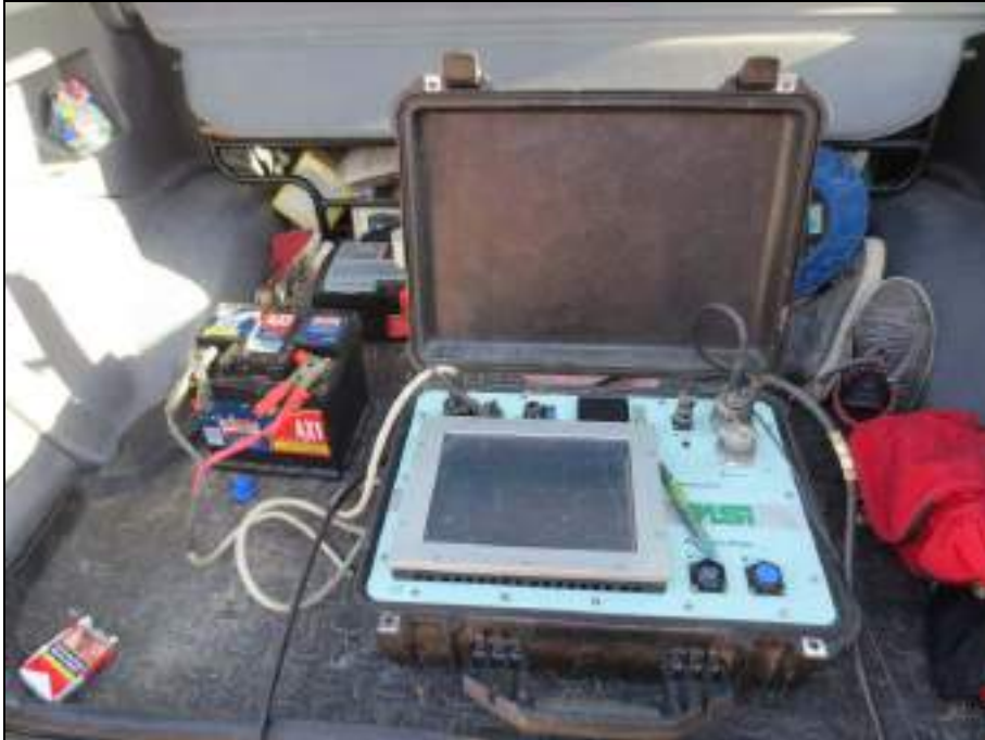
FOTO N°23: STAZIONE DI ACQUISIZIONE DEI PROFILI SISMICI IN ONDE S E MASW (PASI 16S24)
