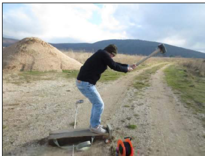
FOTO N°6: ENERGIZZAZIONE ONDE DI TAGLIO
