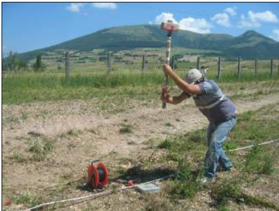
FOTO N°15: ENERGIZZAZIONE ONDE DI COMPRESSIONE
