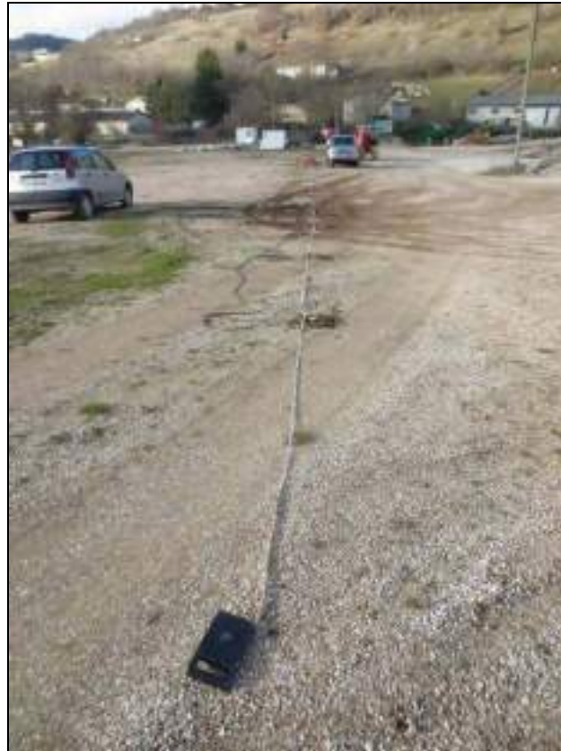
FOTO N°17: STENDIMENTO DEL PROFILO SISMICO IN ONDE "S" E "MASW"
