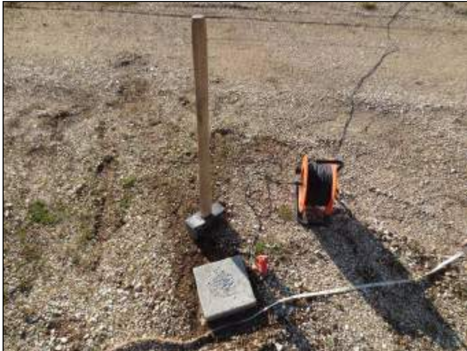
FOTO N°19: PIASTRA DI BATTUTA PER ENERGIZZAZIONE ONDE DI COMPRESSIONE
