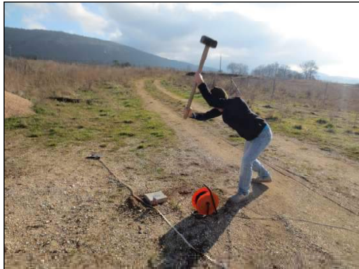
FOTO N°5: ENERGIZZAZIONE ONDE DI COMPRESSIONE
