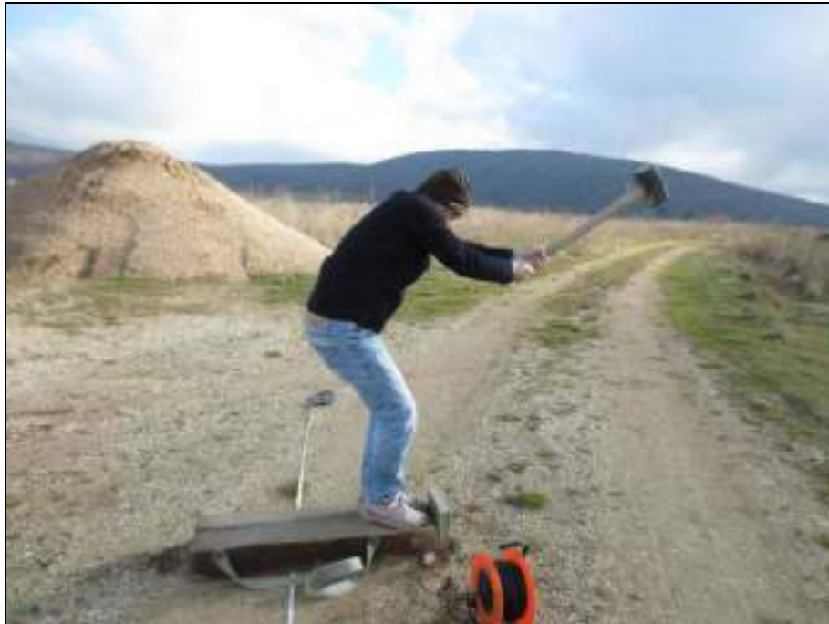
FOTO N°21: ENERGIZZAZIONE ONDE DI TAGLIO
