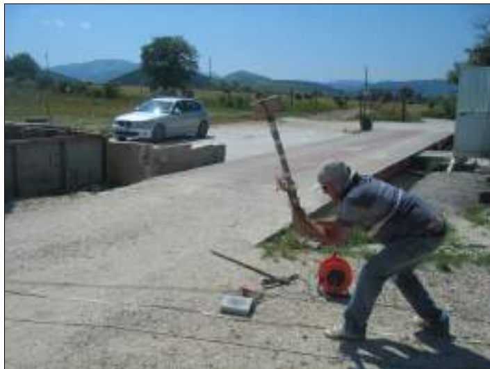
FOTO N°2: ENERGIZZAZIONE ONDE DI COMPRESIONE - PROFILO SISMICO IN ONDE P
