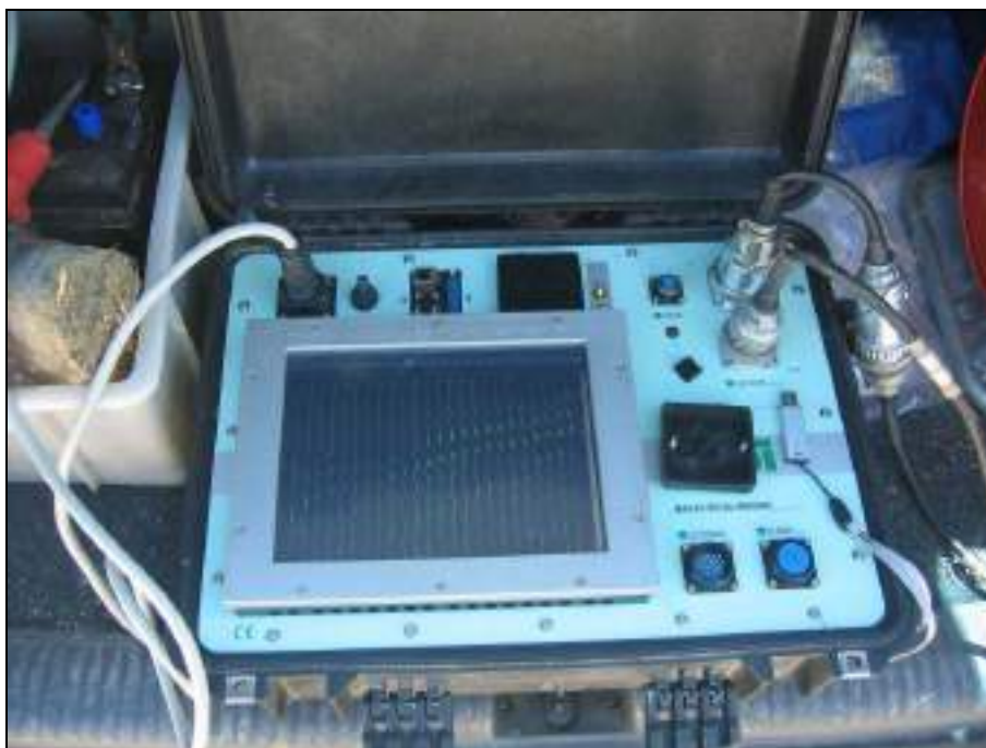
FOTO N°16: STAZIONE DI ACQUISIZIONE DEL PROFILO SISMICO IN ONDE P (PASI 16S24)
