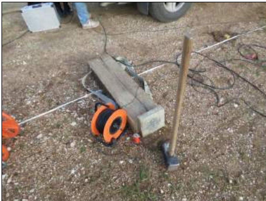
FOTO N°20: PIASTRA DI BATTUTA PER ENERGIZZAZIONE ONDE DI TAGLIO
