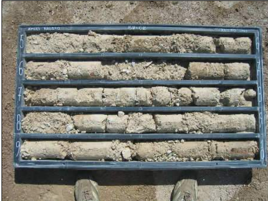
FOTO N°9: CASSETTA CATALOGATRICE N°2 DEL SONDAGGIO N°2 (da 5 m a 10 m)
