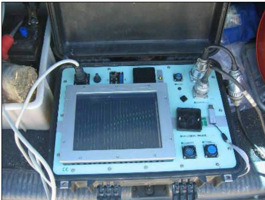
FOTO N°16: STAZIONE DI ACQUISIZIONE DEL PROFILO SISMICO IN ONDE P
