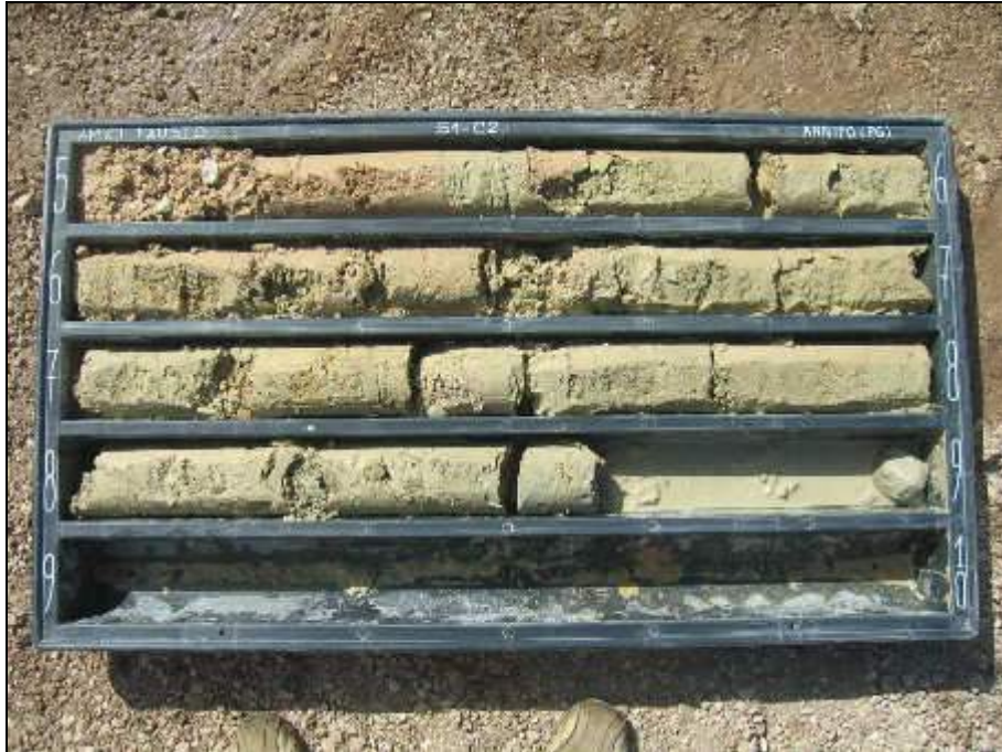
FOTO N°3: CASSETTA CATALOGATRICE N°2 DEL SONDAGGIO N°1 (da 5 m a 9 m)
