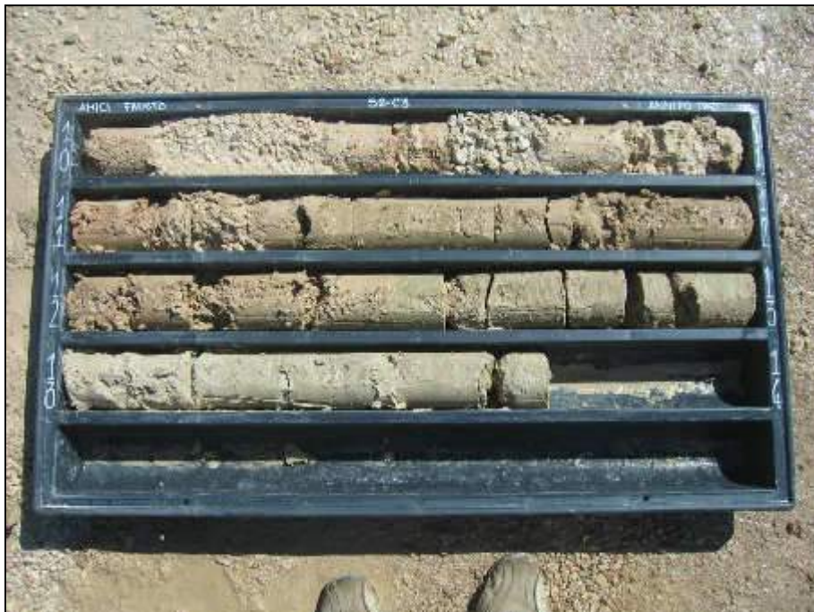
FOTO N°10: CASSETTA CATALOGATRICE N°3 DEL SONDAGGIO N°2 (da 10 m a 13,8 m)
