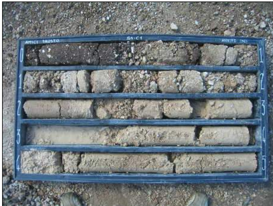
FOTO N°2: CASSETTA CATALOGATRICE N°1 DEL SONDAGGIO N°1 (da 0 m a 5 m)
