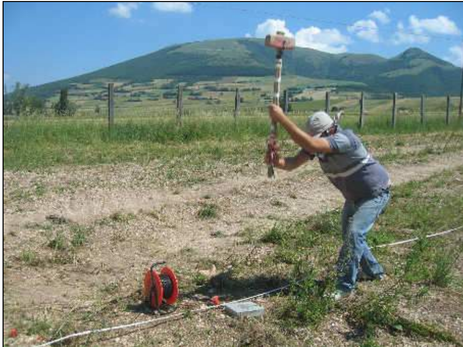
FOTO N°15: ENERGIZZAZIONE ONDE DI COMPRESSIONE
