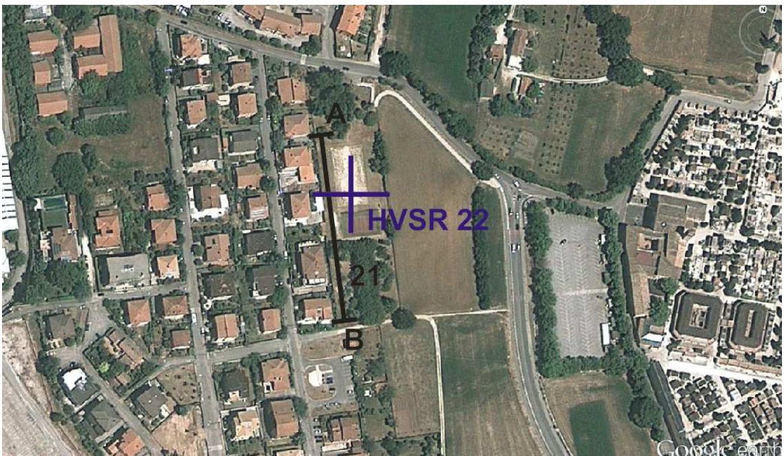
Profilo sismico 21 (120 m, parco vicino cimitero). Sismica a rifrazione SH e profilo MASW (a traccia coincidente). Punto di indagine HVSR 22.
