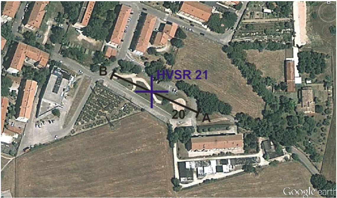
Profilo sismico 20 (96 m, parcheggio vicino via Piave). Sismica a rifrazione SH e profilo MASW (a traccia coincidente). Punto di indagine HVSR 21.
